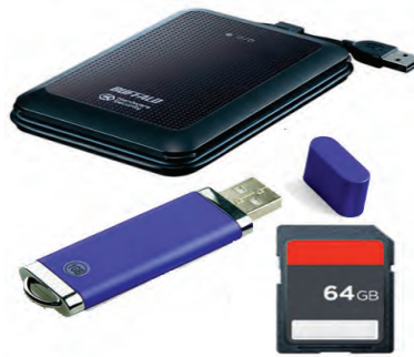
Resim 1.6: USB bağlantılı sabit disk, flash disk ve hafıza kartı
